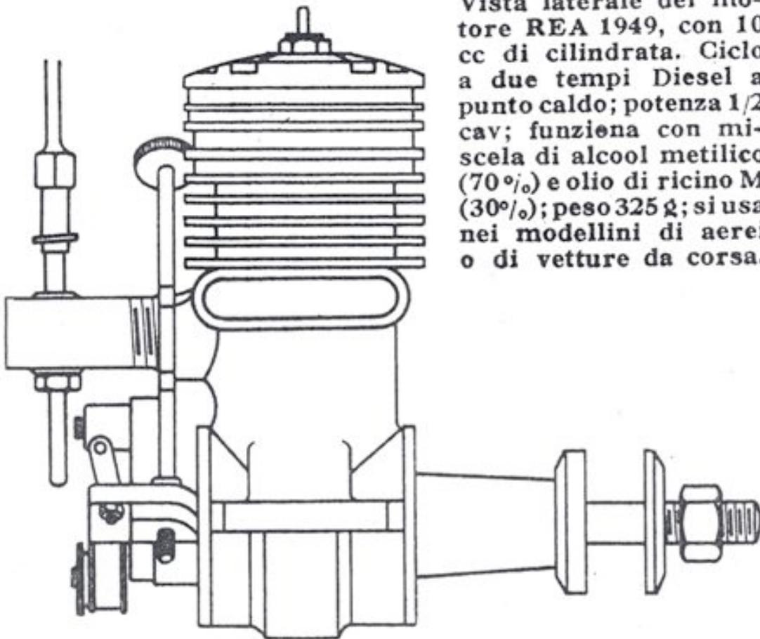
Vista laterale del motore REA 1949, con 10 cc di cilindrata. Ciclo a due tempi Diesel a punto caldo; potenza 1/2 cav; funziona con miscela di alcool metilico (70%) e olio di ricino M (30%); peso 325 g; si usa nei modellini di aerei o di vetture da corsa.
